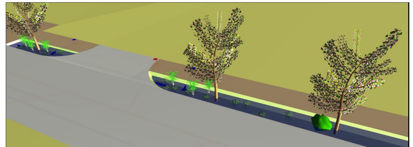
Figure 10 : Noues en 3D (Source : Cabinet Merlin)
