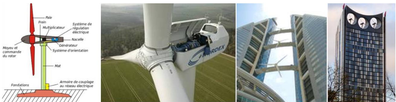
Figure 25 : Eoliennes à axe horizontal
