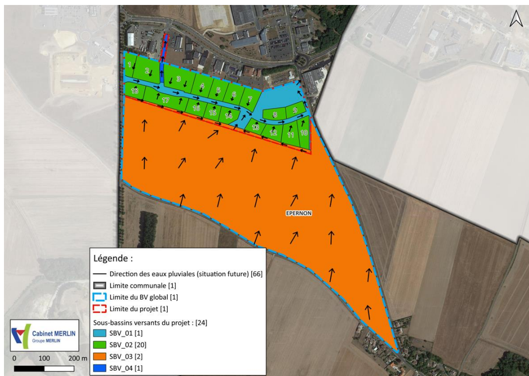
Figure 3 : Délimitation des sous-bassins versants
