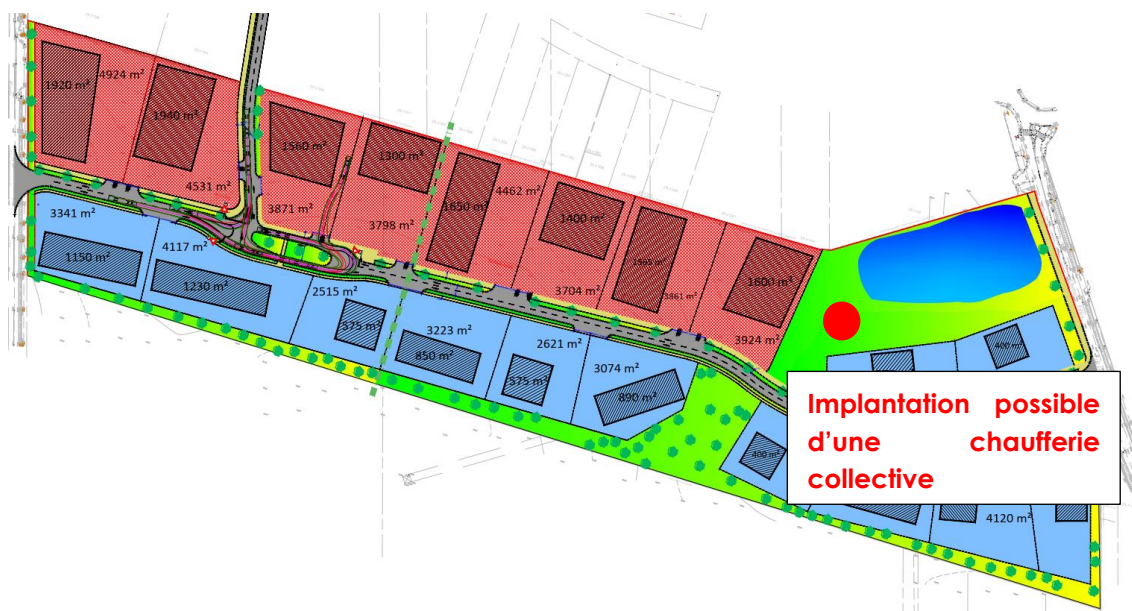
Figure 42 : Implantation possible d'une chaufferie collective
