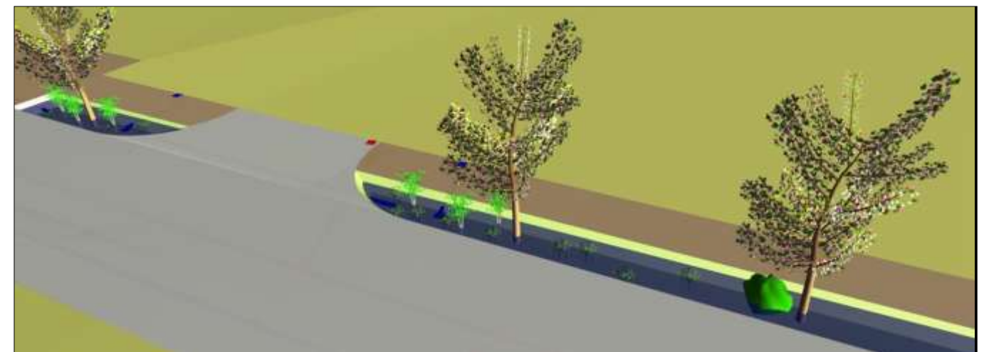
Figure 44 : Noues en 3D (Source : Cabinet Merlin)
