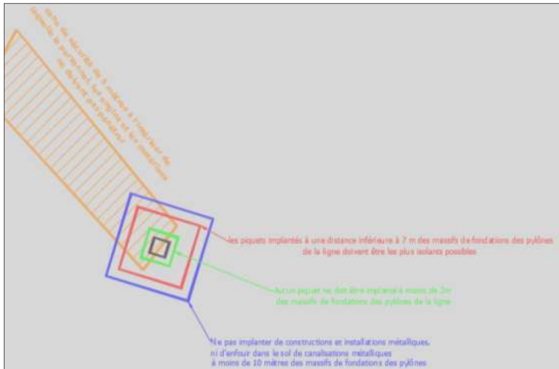
Figure 37 : Les différentes restrictions concernant les pylônes (Source : RTE)
